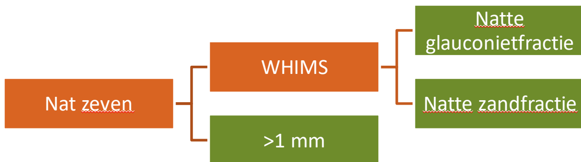
Figuur 10: Vereenvoudigd processchema van het natte magnetische scheidingsproces.
