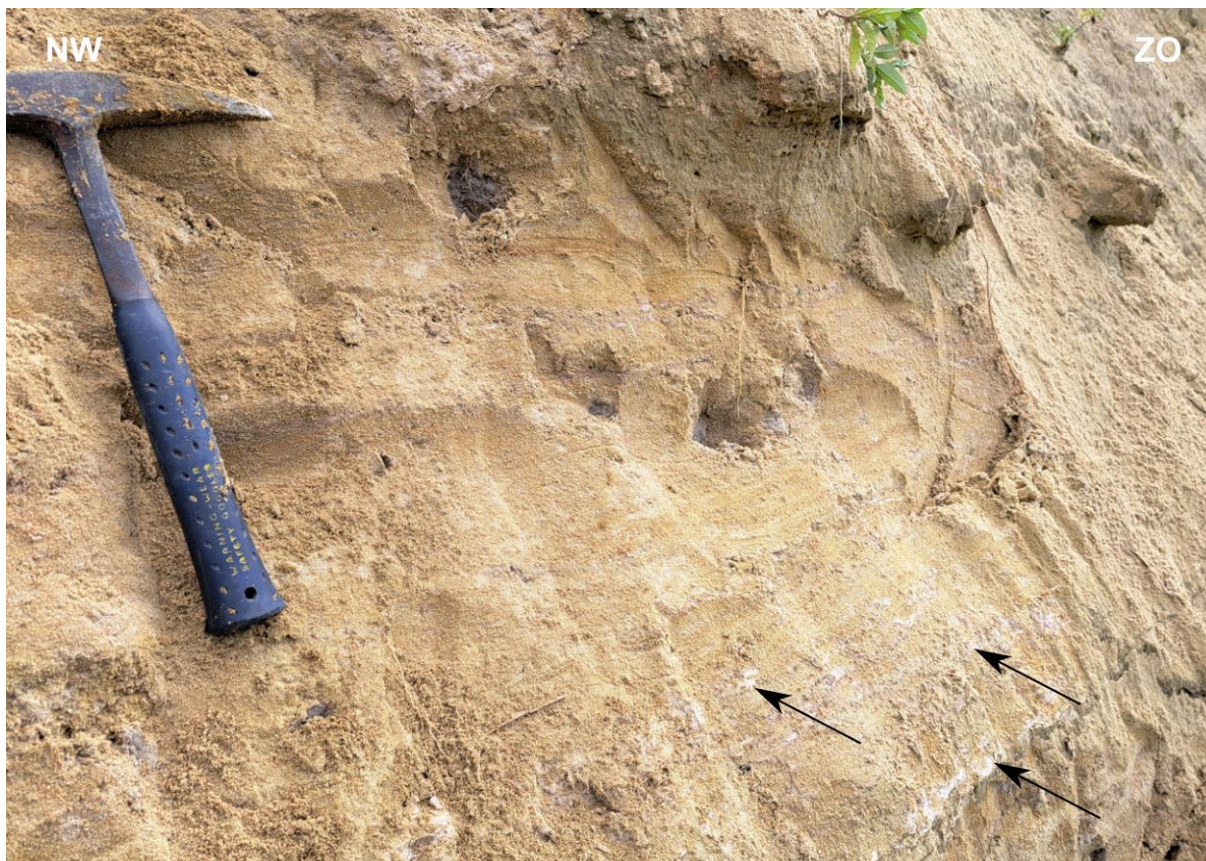
Figuur 7. Foto van pakket 2 van sectie 1, met aanduiding van de horizontale grijze kleilaagjes.
