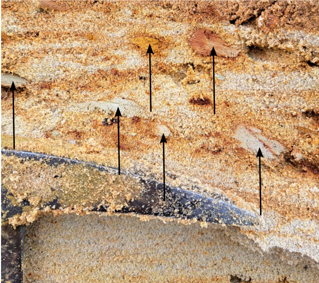
Figuur 17. Detail van de kleibrokken in het grof zand van P0.1.
