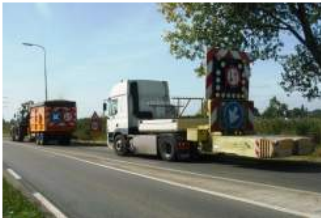
Foto 5-4: Klepelmaaier gevolgd door botsabsorbeerder
