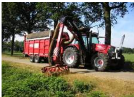
Foto 5-1: Klepelmaaier met maai-zuigcombinatie (bron: Pro Natura, 2010)
