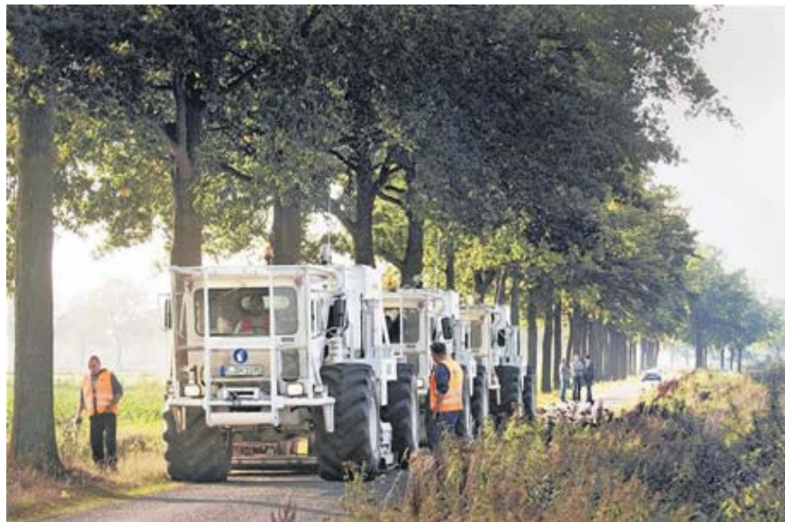
Figuur 15: Vibroseismische campagne (DMT) rond Horst
