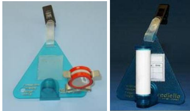
Figuur 4: persoonlijke samplers voor NO 2 (links) en VOS (rechts)
