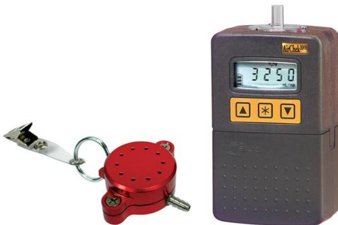
Figuur 5: Voorbeeld van een PEM (personal environmental monitor voor PM 2.5 )
