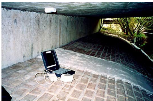
Figuur 6.2 Sporenbed (zand) en faunadetector met chip voor registratie van passages. Met de laptop worden de gegevens uitgelezen en opgeslagen.
