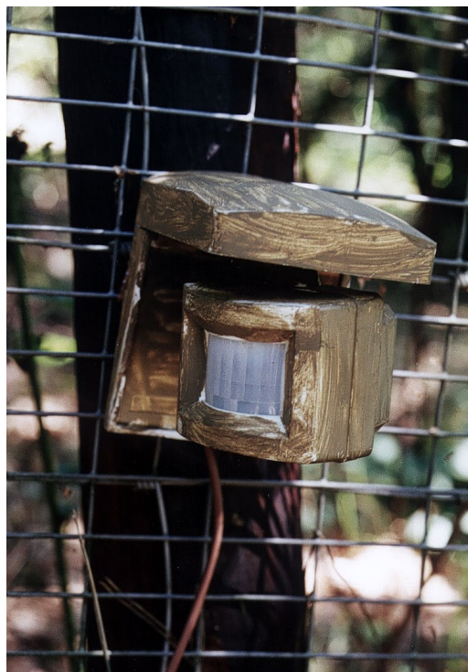
Figuur 6.25 Passief infrarooddetector in camouflagekleur.
