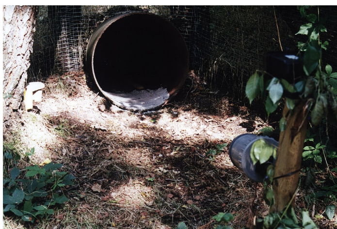
Figuur 6.14 Infraroodvideocamera (onder) en infraroodschijnwerper aan paaltje voor ingang faunabuis, links aan boom een infrarooddetector waarmee de videocamera aangestuurd wordt bij passage van een dier.
