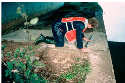
Figuur 6.3 Het sporenbed van zilverzand wordt gladgerold met een pvc-buis.
