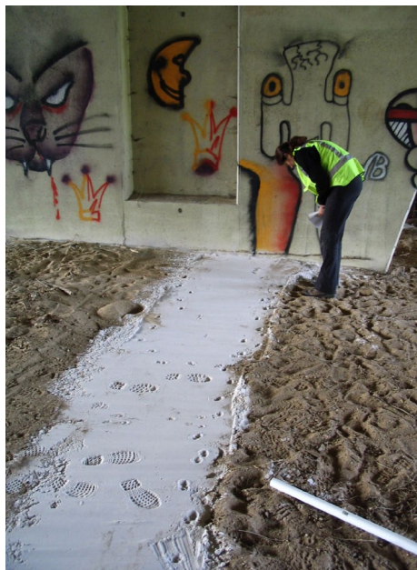
Figuur 6.19 Uitlezen van een belopen zandbed. Met de op de foto zichtbare kunststof buis wordt het zand nadien weer glad gestreken.
