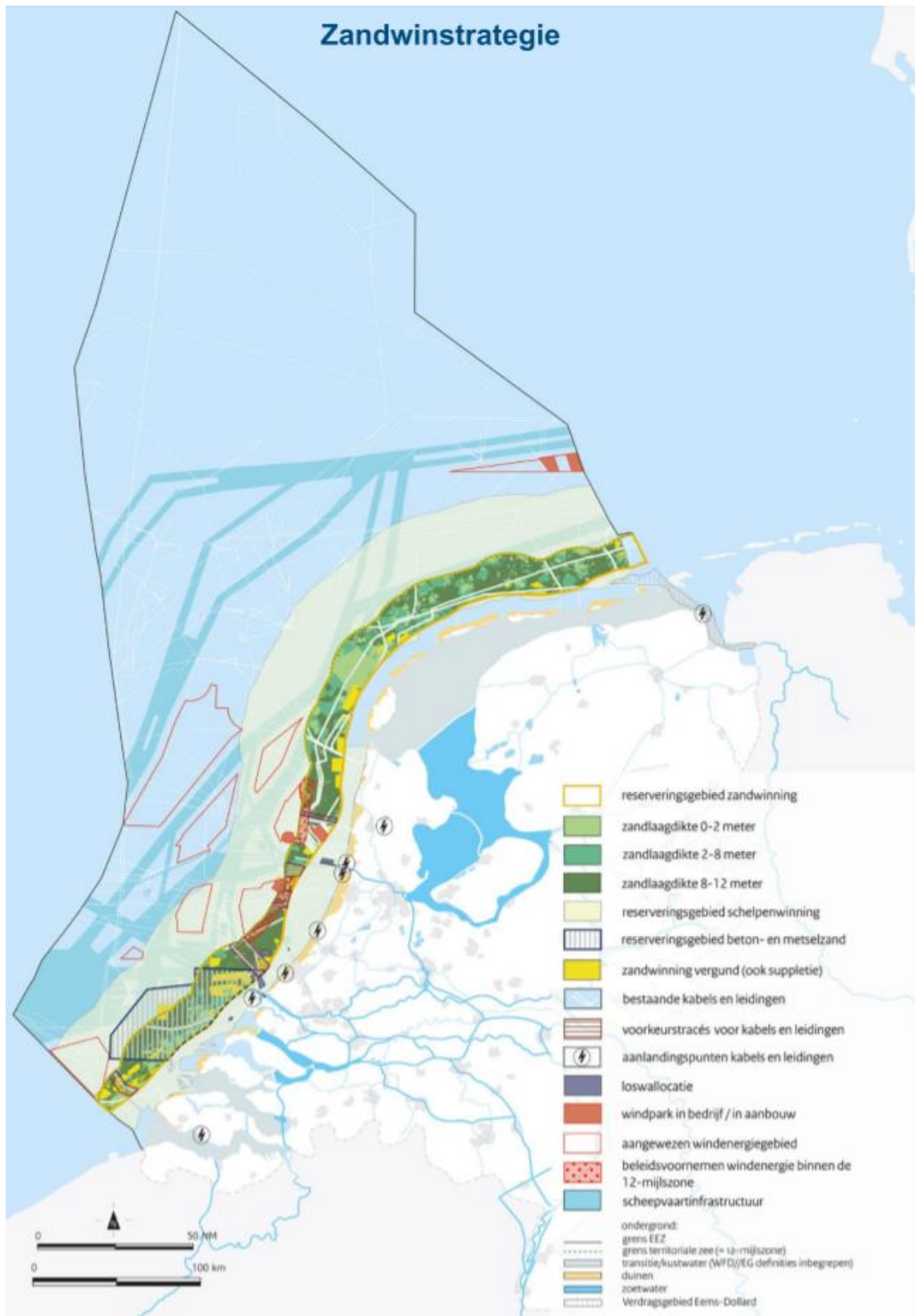
Figuur 24: Overzicht van de zandwinningszones en dieptes op het Nederlands deel van de Noordzee
