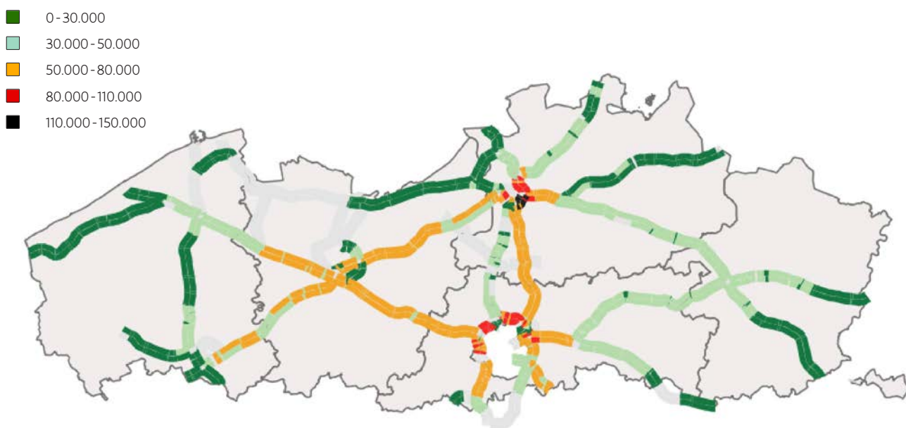
FIGUUR 6.28: VERKEERSVOLUME: GEMIDDELD AANTAL VOERTUIGEN PER WEGSEGMENT OP WERKDAGEN TIJDENS SCHOOLDAGEN, 2017 (Vlaams Verkeerscentrum, 2017)
