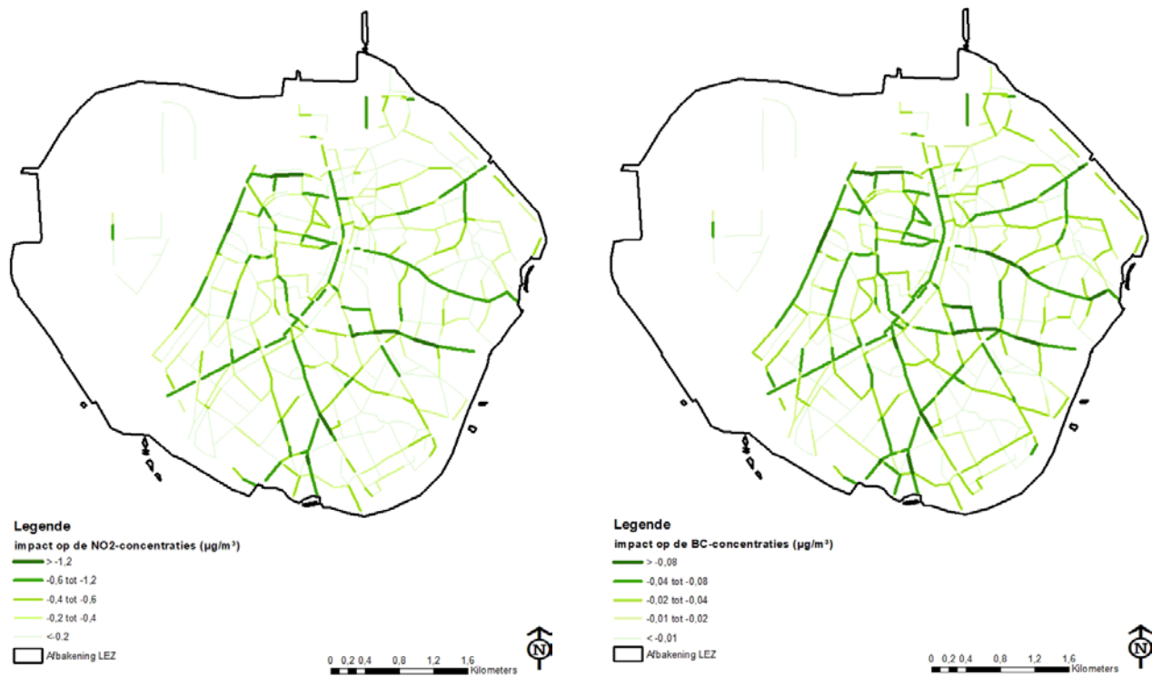
Figuur 32: Gemodelleerde impact van de verstrenging van de toegangs criteria in de lage-emissiezone van Antwerpen op de \text{NO}_2 -concentraties (links) en de roetconcentraties (rechts) in 2019
