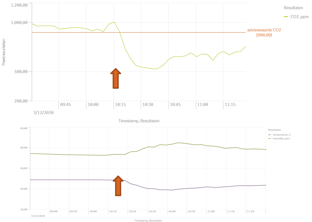
Figuur 9 Verloop van CO 2 -concentratie (in ppm) (figuur boven), temperatuur (in °C) en relatieve vochtigheid (in %) (figuur onder) op 3/12/2020 van 9u30 tot 11u30 bij deur dicht en 6 ramen open (school 4, lokaal 1, gemiddelde bezetting) – gemiddelde dagtemperatuur = 5,5°C
