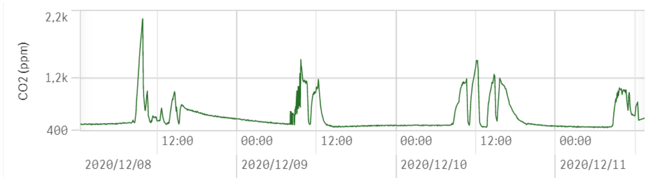
Figuur 14 Verloop van de CO 2 -concentratie tijdens de meetperiode van 8/12/2020 tot 11/12/2020 (school 5, lokaal 1, gemiddelde bezetting)
