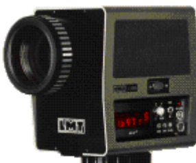
Figuur 5 De LMT luminantiemeter Bron: LMT LICHTMESSTECHNIK GMBH BERLIN
