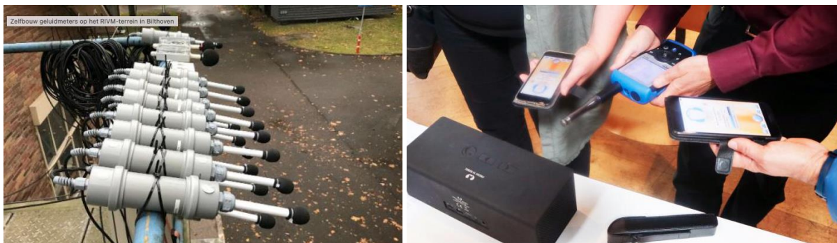
Figuur 10: kalibratie decibelometers, zelfbouw (links) en smartphone app (rechts) (RIVM)
