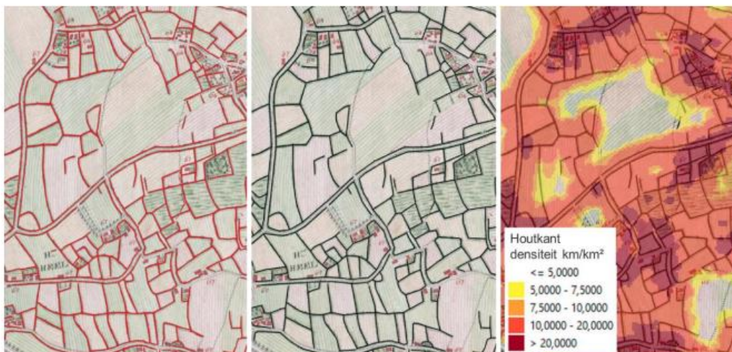
Figuur 4-4 Van gedetecteerde houtkanten (polygonen) naar lijnen en dan naar lijndensiteit (Ferrariskaart)
