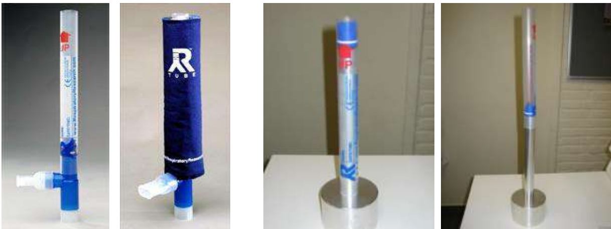
Figuur 2: De RTube. Het toestel bevat een mondstuk, een speekselval en een collectiebuis. Deze is omgeven door een koud metaal en isoleerhuls tijdens de collectie. In de rechtse foto's wordt geïllustreerd hoe EBC verzameld wordt met de RTube.
