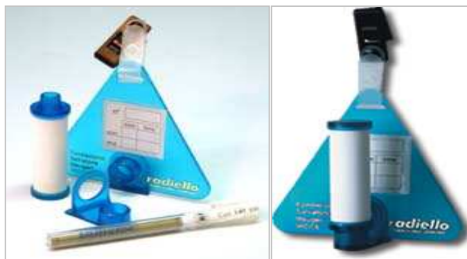
Figuur 4: Diffuse 'Radiello' sampler. De (witkleurige) diffusieve cilinder is 5 cm lang en heeft een diameter van 16 mm. Het adsorbens (530 mg actieve kool) is in een lang, smal inox cilindervormig net verpakt en wordt in de diffusieve polyethyleencilinder (HDPE) gemonteerd bij aanvang van de bemonsteringsperiode. Na opschroeven van de cilinder op het 'draagplaatje' is de sampler klaar voor bevestiging aan de kledij van de proefpersoon.
