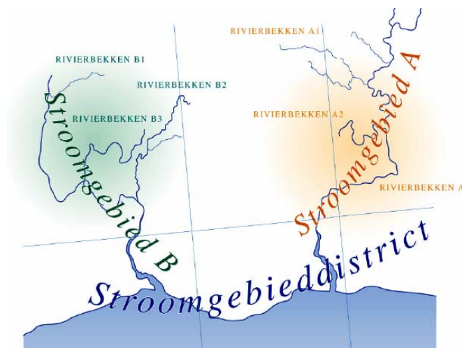
Figuur 4: Schematische voorstelling van de begrippen stroomgebied, stroomgebiedsdistrict, bekken (A en B), en deelbekken (A1 en A2)
