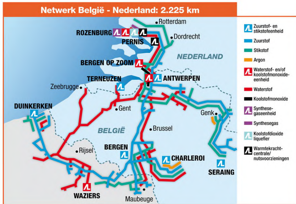
Figuur 9: Netwerk van technische gassen
