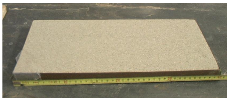
Figuur 13. De testpan van 40 cm x 20 cm x 2 cm gevuld met duinzand
