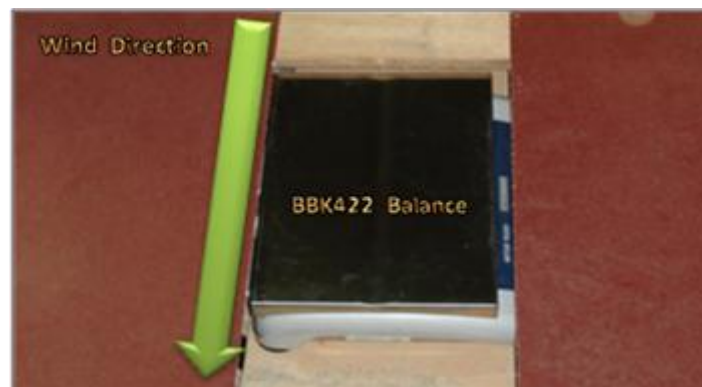
Figuur 14. De balans waarop de bodemchaal werd geplaatst. Rondom de balans werd schuurpapier met dezelfde oppervlakteruwheid als een onbedekte bodem aangebracht
