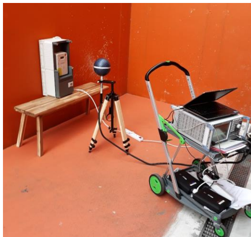
Figuur 1: Meetopstelling van de spectrumanalyser en de tri-axiale antenne.
