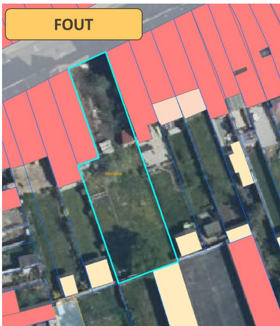
Figuur 16: Links: Illustratie van een perceel uit het, door de gemeente aangeleverde ROP (lichtblauwe polygoon), dat ten onrechte niet werd opgenomen in het automatisch gegenereerde ROP omdat de berekeningswijze voor de parameter 'percelen die een volledig bebouwd perceel omvatten (zie 2.3.2.8)' het aangrenzende volledig bebouwde perceel beschouwt als omvat door het geselecteerde perceel. Rechts: correcte toepassing van bovenstaande parameter.
