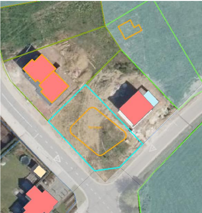
Figuur 15: illustratie van een perceel uit het, door de gemeente aangeleverde ROP (lichtblauwe polygoon), dat terecht niet werd opgenomen in het automatisch gegenereerde ROP. Het perceel werd ondertussen bebouwd. De bebouwing werd gedetecteerd (oranje polygoon) maar nog niet gekarteerd in de Basiskaart Vlaanderen (GRB).
