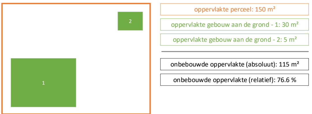
Figuur 2: illustratie van de berekening van de parameter ‘onbebouwde oppervlakte (absoluut en relatief)’ op basis van de entiteiten administratief perceel (Adp) (oranje) en gebouw aan de grond (Gbg) uit de Basiskaart Vlaanderen (GRB).
