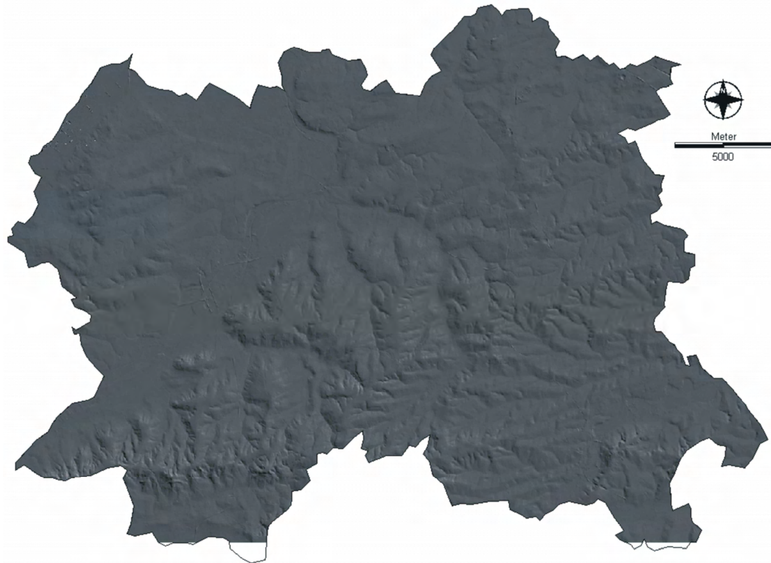
Figuur 2.6: Schaduwkaart van de Vlaamse Ardennen. De lichtbron bevindt zich ten noordoosten van het kaartblad. Digitaal Terreinmodel op basis van laserscanning of LIDAR (Light Detection and Ranging; OC GIS-Vlaanderen, 2005)
