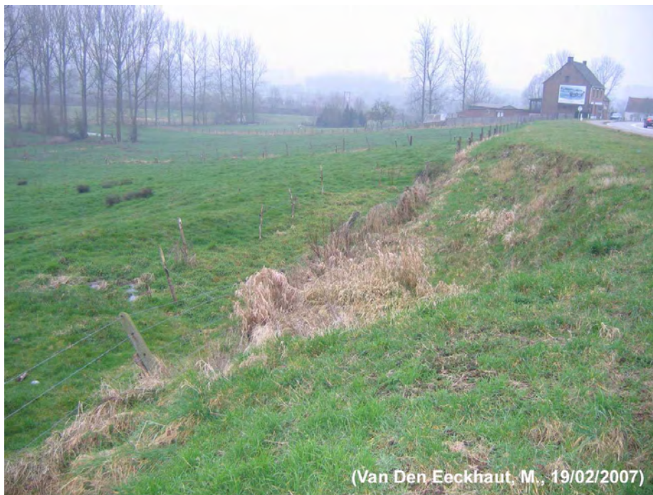
Foto 1 : Zicht op deel van hoofdsteilrand van GV. 141. Let op de weggeduwde en scheefgestelde palen in de weide en op de waterstagnatie hellingafwaarts van de hoofdsteilrand.
