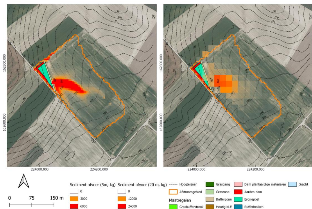
Figuur 58: Modelling van het sedimenttransport in het afstroomgebied te Widoorie met resoluties 5 m (links) en 20 m (rechts) en gebruik makend van een standaard R-waarde van 1250 \text{ MJ.mm.ha}^{-1}.\text{h}^{-1}.\text{jaar}^{-1} . De coördinaten zijn uitgedrukt in Lambert 1972.
