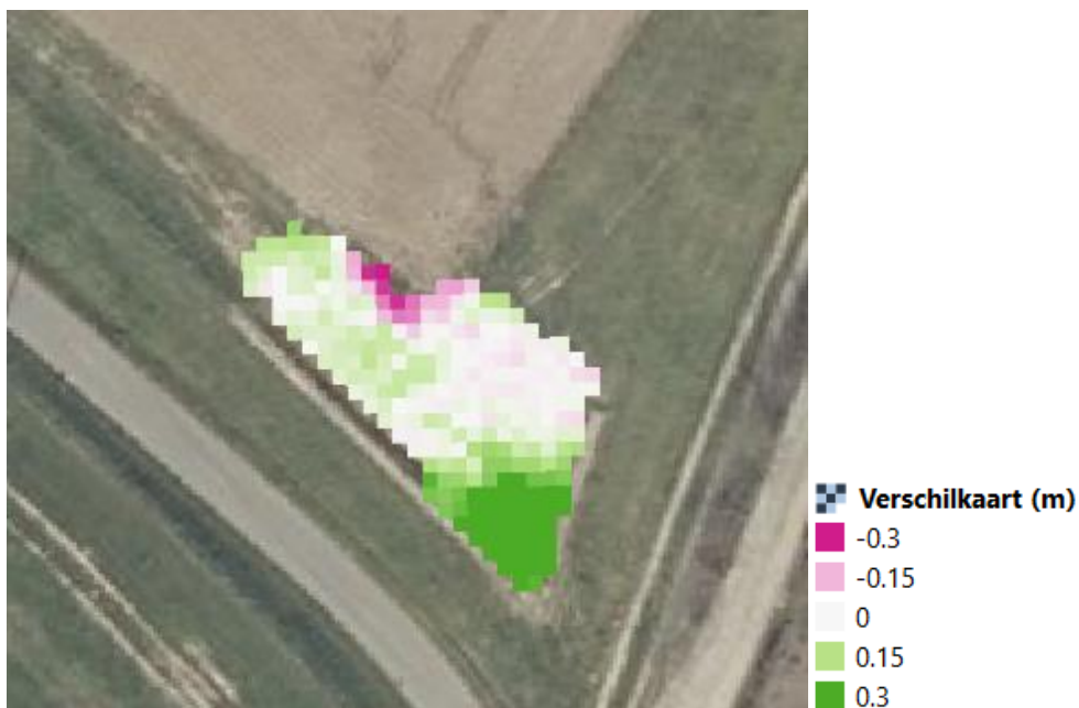
Figuur 30: Hoogteverschillen in Wortegem-Petegem tussen de opmetingen van 20/3/2019 en 14/6/2019.
