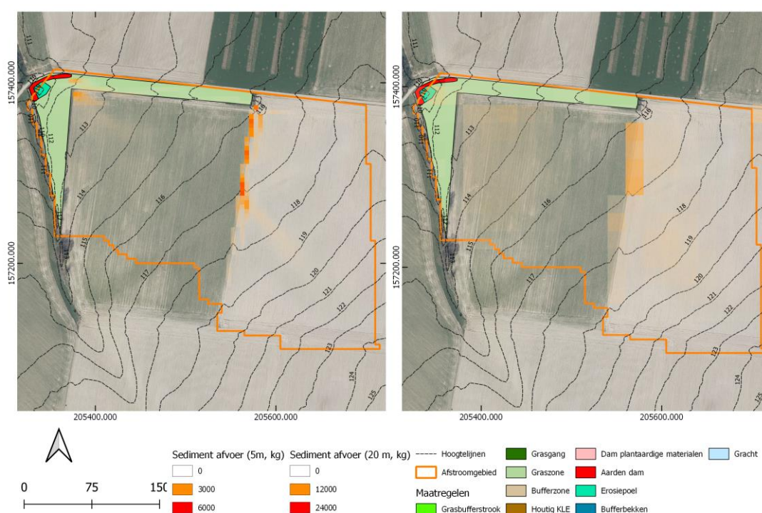
Figuur 60: Modellerings van het sedimenttransport in het afstroomgebied te Borlo met resoluties 5 m (links) en 20 m (rechts) en gebruik makend van een standaard R-waarde van 1250 \text{ MJ} \cdot \text{mm} \cdot \text{ha}^{-1} \cdot \text{h}^{-1} \cdot \text{jaar}^{-1} . De coördinaten zijn uitgedrukt in Lambert 1972.
