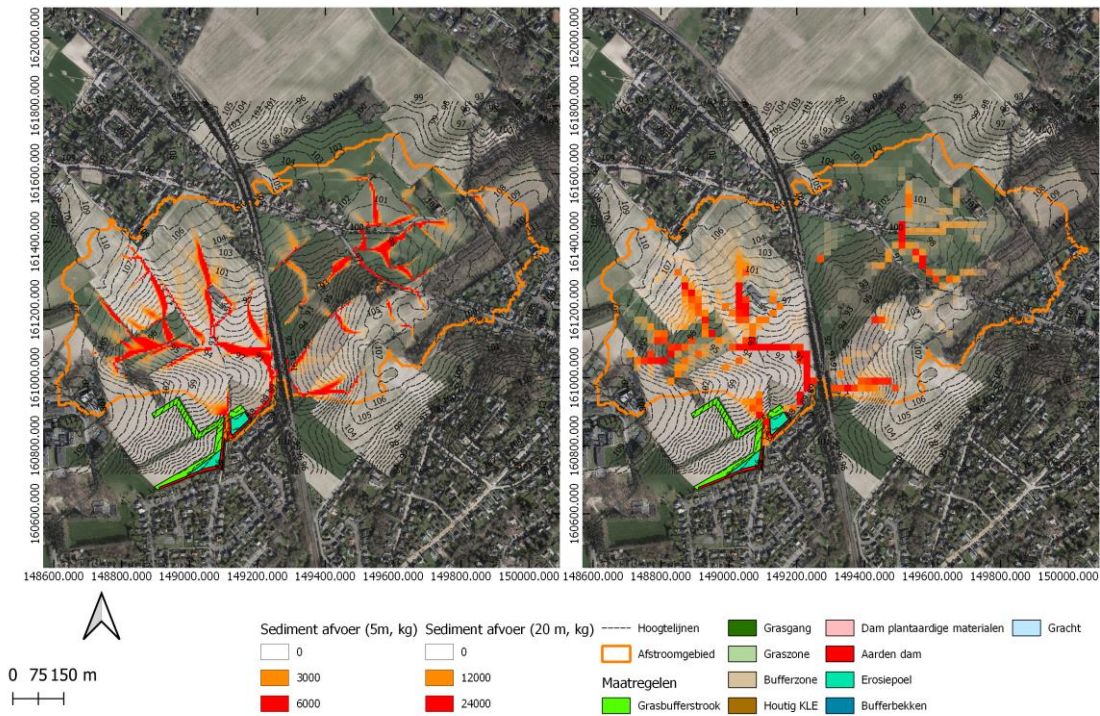
Figuur 64: Modelling van het sedimenttransport in het afstroomgebied te Sint-Genesius-Rode met resoluties 5 m (links) en 20 m (rechts) en gebruik makend van een standaard R-waarde van 1250 MJ.mm.ha -1 .h -1 .jaar -1 . De coördinaten zijn uitgedrukt in Lambert 1972.
