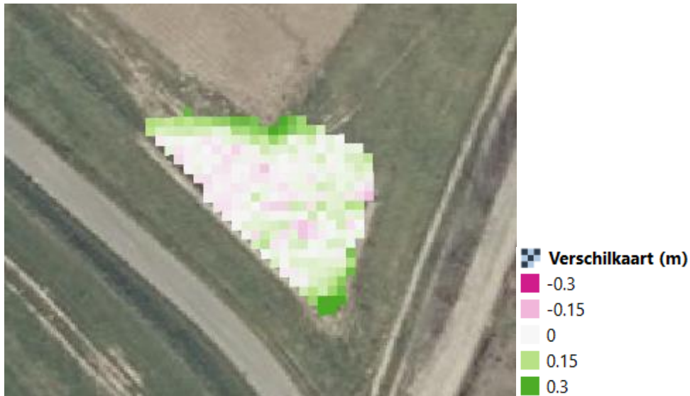
Figuur 29: Hoogteverschillen in Wortegem-Petegem tussen de opmetingen van 18/12/2017 en 20/3/2019.
