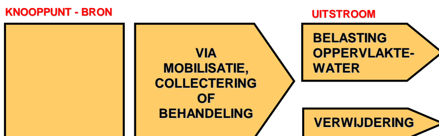
Figuur 3.3: Algemeen massabalansprincipe zoals toegepast in de Emissie-Inventaris Water: de totale belasting naar het oppervlaktewater is gelijk aan de emissie bij de bron minus de verwijderde verontreiniging of transfer naar een ander knooppunt.
