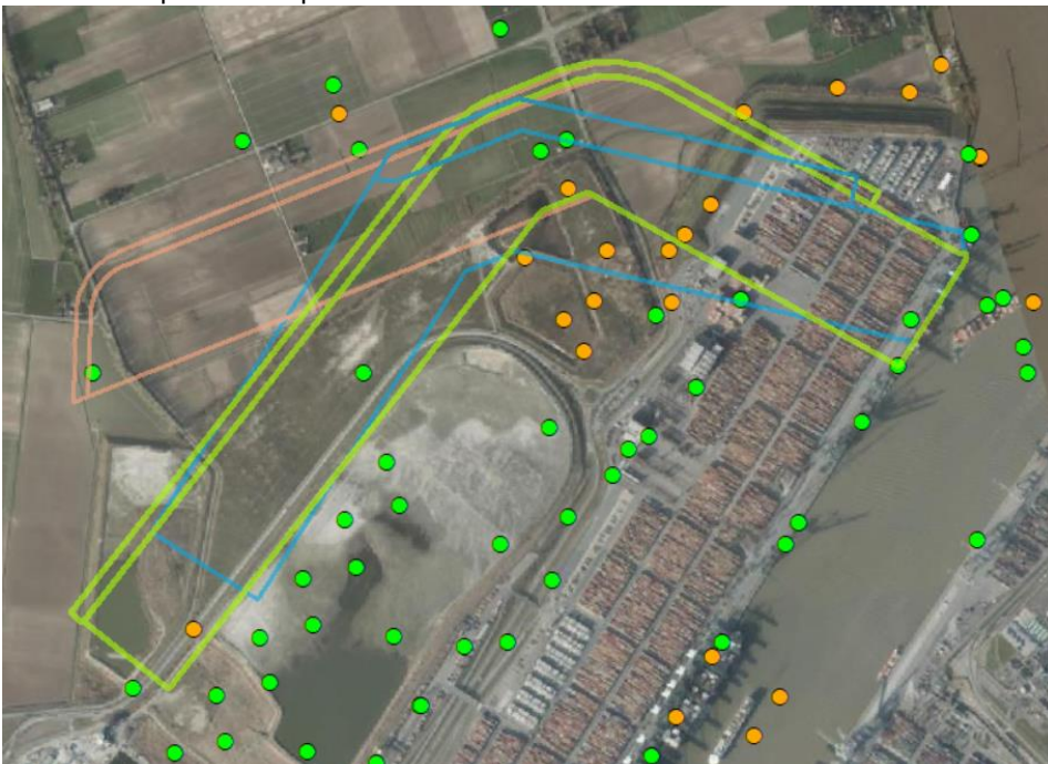
Figuur 4: Verdeling van de boringen (groen) en sonderingen (oranje) waarop het model voor het Lid van Rotselaar gebaseerd is (bron datapunten DOV).
