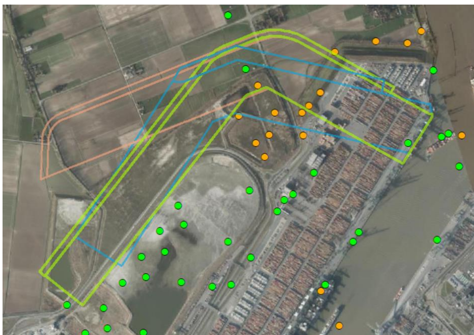
Figuur 5 Verdeling van de boringen (groen) en sonderingen (oranje) waarop het model voor het Lid van Wichelen gebaseerd is (bron datapunten DOV).
